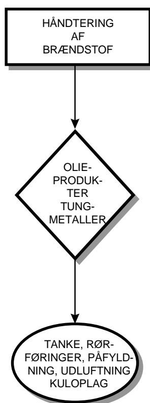
Figur 4.3 Oversigt over arbejdsmetoder, potentielt forurenende stoffer/produkter samt potentielle forureningskilder ved håndtering af brændstof
